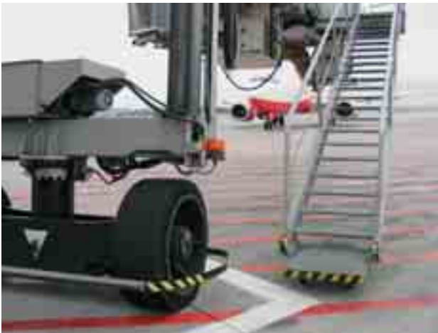
Obr. 3 Letištní vozovky jsou zatěžovány i plnými koly, pohled na podvozek nástupního mostu
