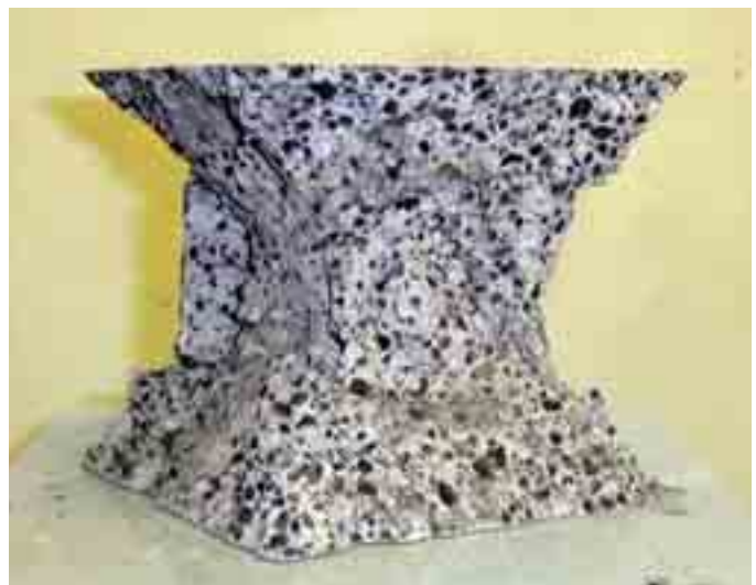
Obr. 3 Zkušební těleso po zkoušce pevnosti betonu v tlaku Fig. 3 Test specimen after compression strength test
