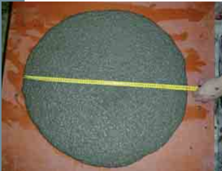
Obr. 1 Konzistence po 60 min. (rozlít) Fig. 1 Consistency after 60 min. (Slump test)
