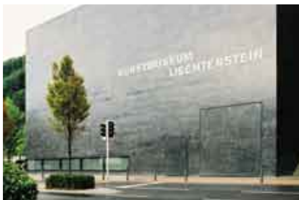
Obr. 2 Budova Lichtenštejnského muzea výtvarného umění ve Vaduzu s fasádou z broušeného a leštěného betonu napuštěného voskem, Lichtenštejnsko, Morger & Degelo, architekt Degelo říká: „fasádu je třeba pravidelně napouštět voskem a leštit jako si pravidelně krémujeme a leštíme boty“, přednáška, Praha 2004
