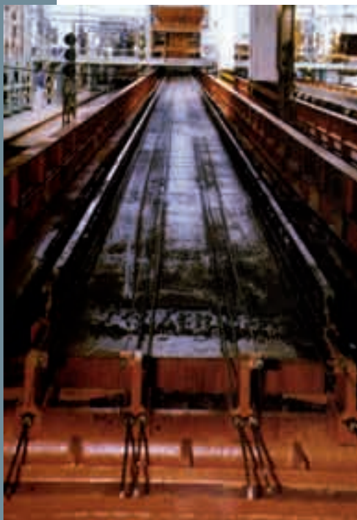
Obr. 9 Čelo rozpěry Spandeck Fig. 9 End of the mould Spandeck
