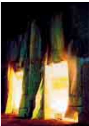
Pohled na okenní otvory při plně rozvinutém požáru
