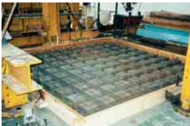
Obr. 3 Experimentální ověření kazetové desky 3,25 x 3,25 m ve zkušebních laboratořích FSv ČVUT v roce 2000 Fig. 3 Experimental verification of waffle slab in testing laboratories at Fac. of CE CTU in Prague (size of specimen 3,25 x 3,25 m, tested in the year 2000)
