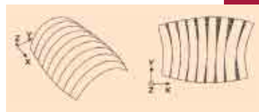
Obr. 1 Škrupina zakrivená v dvoch rovinách a jej rozvinutý základný rovinný tvar Fig. 1 Shell with double curvature and its flattened out initial layout
