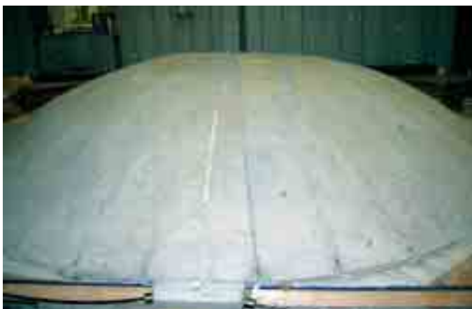
Obr. 5 Škrupina vo vypuklom štádiu Fig. 5 Shell in its buckled final state
