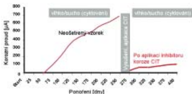
Obr. 4 Výsledky laboratorních zkoušek inhibitoru koroze Protectosil CIT, vzorky betonu 300 x 300 x 75 mm, 15% roztok NaCl, 90% redukce korozního náboje
