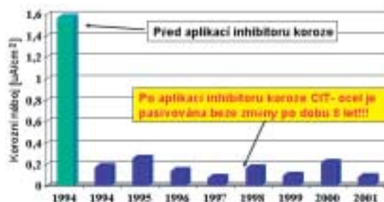
Obr. 6 Hodnoty aktuální míry koroze měřené na stavbě za použití lineárního polarizačního zařízení
