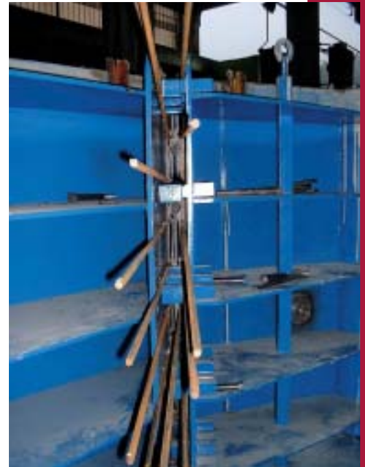
Obr. 4 Detail umístění spřahující výztuže vzpěry ve formě
