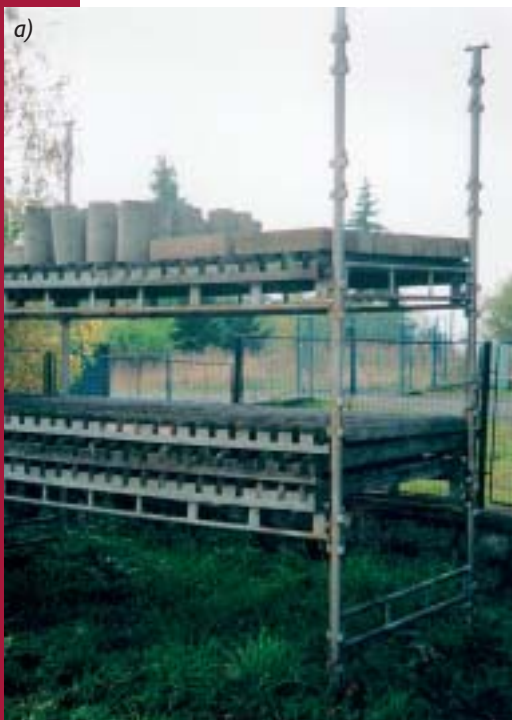
Obr. 1 a) b) Uložení vzorků popílkových a referenčních betonů ve vysokohorské laboratoři
