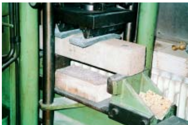
Obr. 3 Zkouška pevnosti v tahu za ohybu Fig. 3 Test of tensile strength by bending
