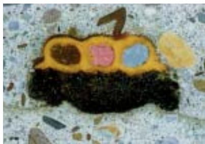
Obr. 5 Řez betonem s dodatečně injektovanou pracovní spárou
