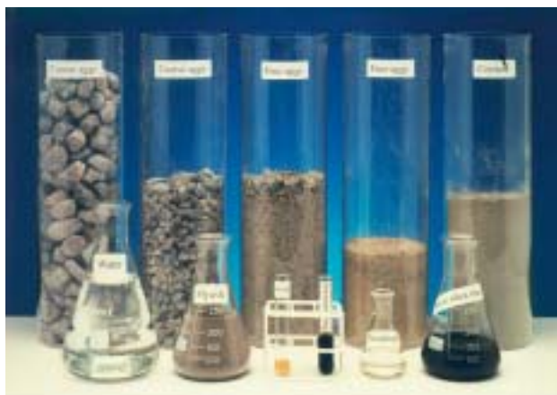
Obr. 6 Typická směs vysokohodnotného betonu, tzv. „koktejlový beton“
