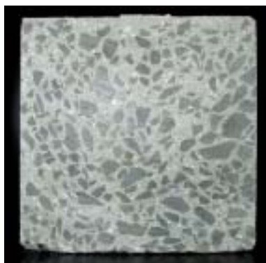
Obr. 1 Řez vysokopevnostním betonem, TBG Metrostav, s. r. o.
