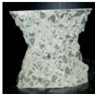
Obr. 2 Struktura „jádra“ krychle z vysokopevnostního betonu po zkoušce pevnosti v tlaku, TBG Metrostav, s. r. o.
