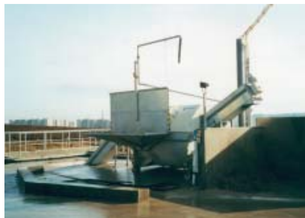
Obr. 15 Zařízení pro recyklaci čerstvého betonu Fig. 15 Facility for recycling of fresh concrete
