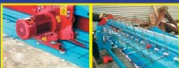
Síť dělíme **STROJOVĚ** (obr.) v případě rovných stíhů nebo **RUČNĚ** (v případě nepravidelných tvarů) pákovými nůžkami a autogenem.
