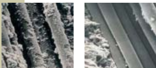
Obr. 3 Vlevo vlákno typu E po několika týdnech v betonu, vpravo vlákno Cem-FIL po několika letech expozice v betonu
