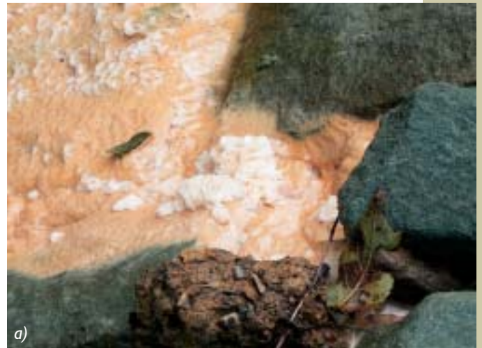
Obr. 4 a) b) Vylučující se uhličitan vápenatý Obr. 4 a) b) Separating calcium carbonate
