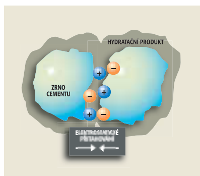
Obr. 1 Chování částic cementového tmele bez užití (super)plastifikační přísady
