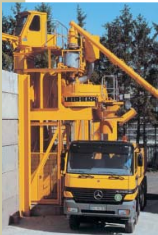
Obr. 1 Přenosná betonárna Liebherr model Compactmix 0,5 o výkonu 43 m 3 za hodinu
