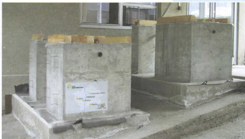
Obr. 1 Stěnové vzorky ze samozhutnitelného betonu
