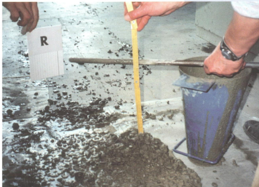
Obr. 2 Měření sednutí kužele (>220 mm – R)
