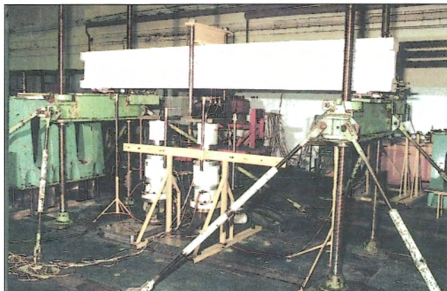
Obr. 2 – Usporiadanie skúšky (nosníky) / Experimental set-up (beams)
