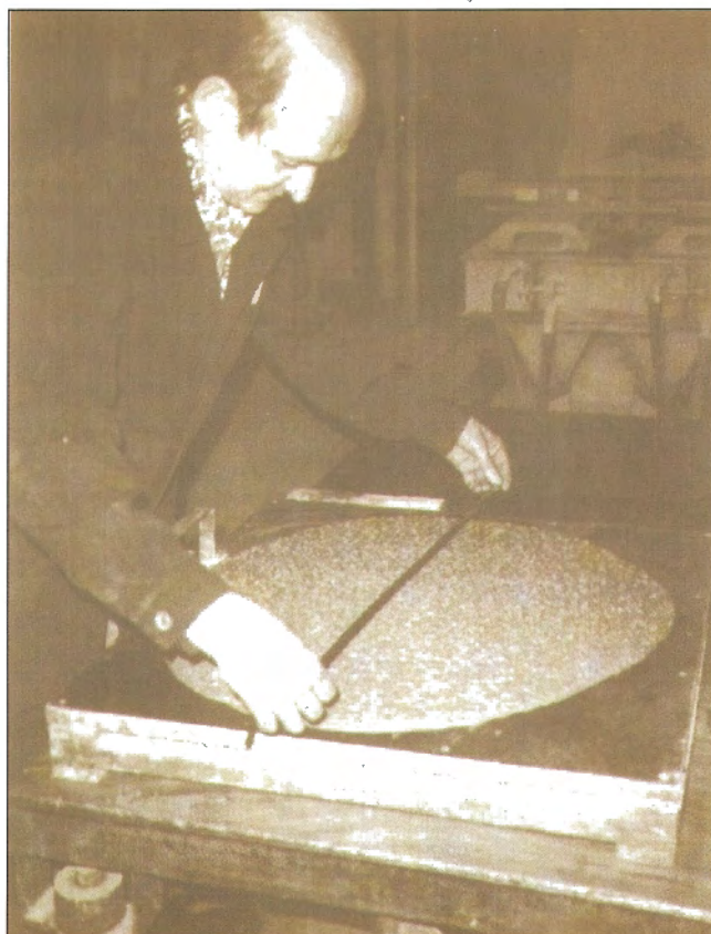
Obr. 7 – Zkouška rozliti čerstvé betonové směsi / Slum flow test
