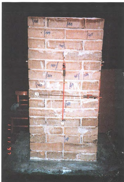
Obr. 2 – Nížká stěna 450 × 600 × 1200 mm / Small wall 450 × 600 × 1200 mm
