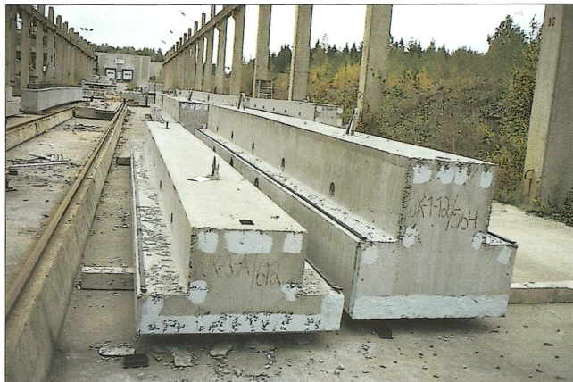
Obr. 14 – Nosníky průřezu obráceného T, Parma Betonila v Nummela / Inverted T-beams. Parma Betonila in Nummela
