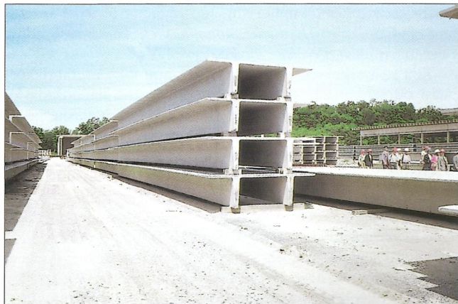
Obr. 12 – Žebrové panely TT délky 30,0 m / TT units, length 30.0 m
