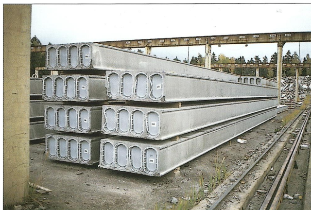
Obr. 3 – Dutinové stropní panely délky 21,0 m / Hollow core slabs, length 21.0 m
