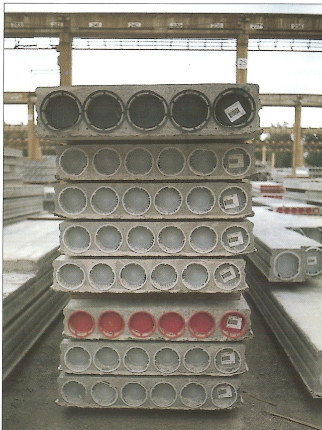
Obr. 1 – Dutinové předem předpínané panely z výroby Parma Betonila v Hyrylä s roční výrobní kapacitou panelů 450 000 m 2 / Hollow core slabs produced by Parma Betonila in Hyrylä, Finland, with the capacity of 450 000 m 2 slabs per year
