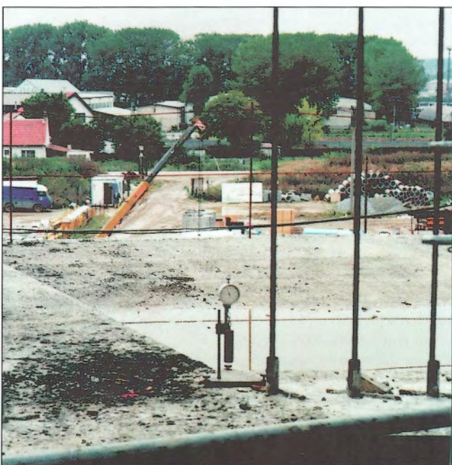
Obr. 4 – Indikátor „a“ pro měření deformací na horním povrchu desky / Surface indicator „a“ for measuring deflections on the upper surface of slab
