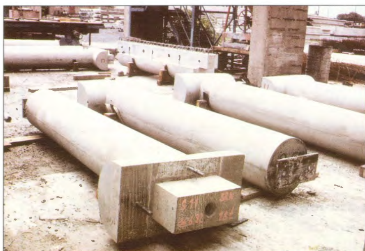
Montovaná administrativní budova v Berlíně, sloup s krátkými konzolami pro uložení tvarovaných nosníků na skládce ve výrobě Preming Chrudim v Opatovicích nad Labem a po jeho zabudování s přiznáním konstrukce v interiéru / Columns with corbels in Manufacturing Plant of Preming Chrudim in Opatovice and the same elements in interior of Office Building in Berlin
