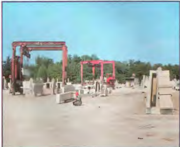
Obr. 18 - Manipulace dílců pojízdnými jeřáby
