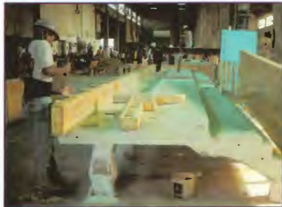
Obr. 17 - Forma parapetního dílce
