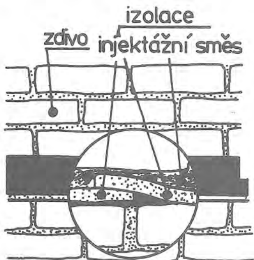
Obr. 4 - Detail podřeznuté a zaizolované zdi
