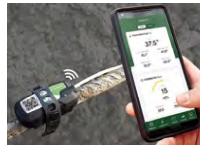
1 Betonáž základu s instalací nosného prstence 2 Provádění betonáže betonem C30/37 - XA1 - D max 16 - S4 3 Betonáž nosného prstence tubusu elektrárny betonem C45/55 - XF3 4 Odečítání teplot pomocí senzoru Giatec 360 bezdrátově pomocí aplikace v mobilním telefonu
